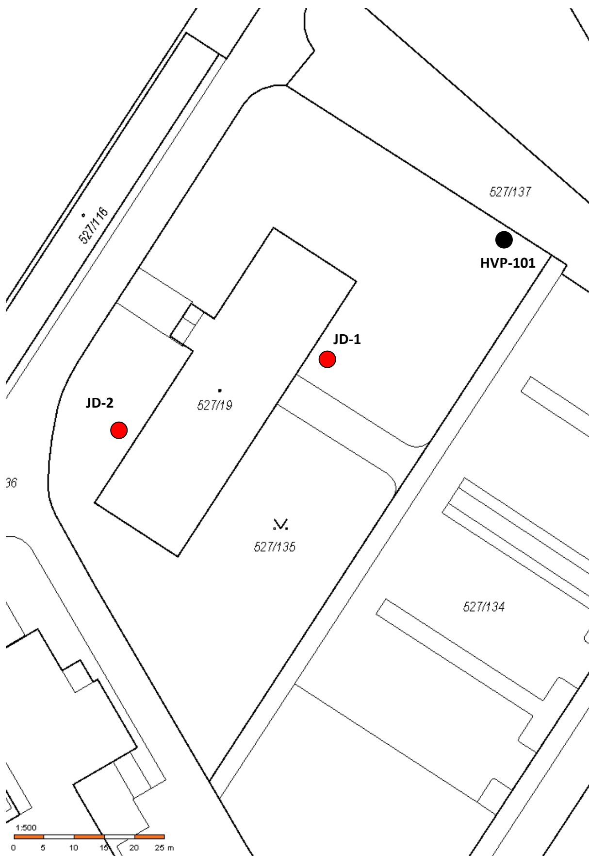
Příloha 2 Situační mapa 1 : 1 000 s pozicí realizovaných sond a starším hydrologickým vrtem HVP-101
